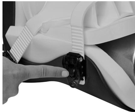
Imagen 19 Accionamiento de la hebilla para liberar la correa dentada
