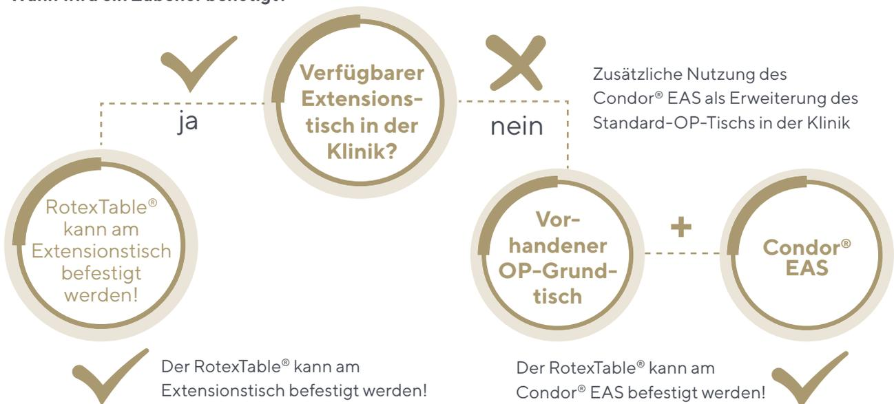
Der RotexTable® wird entweder am vorhandenen Extensionstisch befestigt oder benötigt zusätzlich das Condor® EAS, um an einem vorhandenen OP-Grundtisch angeschlossen werden zu können.
