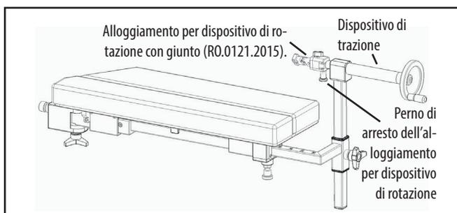
L'adattatore del dispositivo di rotazione (RO.0202.2019) vi consentirà di usufruire in via opzionale di quattro opzioni di impostazione per regolare con precisione la rotazione del piede:
